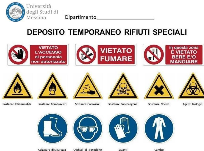
Figura 3 – Cartellonistica da apporre all'ingresso del Deposito Temporaneo
