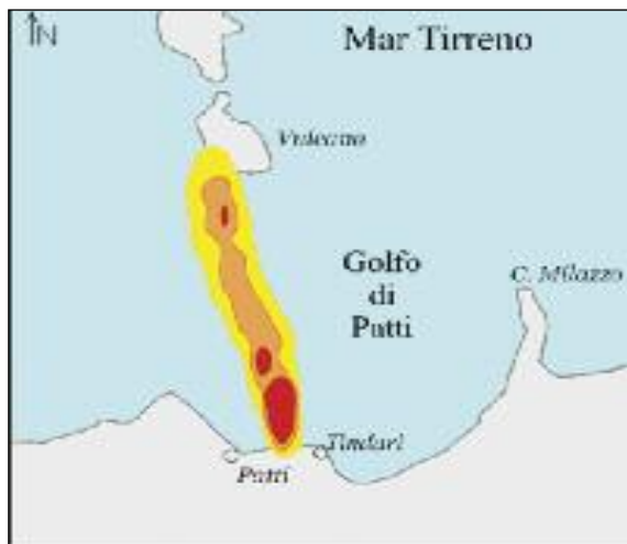
Figura 3. Localizzazione della sequenza sismica del Febbraio 1999 nel Golfo di Patti, effettuata con il metodo probabilistico non-lineare BAYLOC di Presti et alii (2008). Questo metodo fornisce, per ciascun terremoto, una nuvola di probabilità che individua la zona nella quale l'evento si è originato. La somma delle nuvole di probabilità dei singoli terremoti della sequenza (mappa cumulativa di localizzazione) indica l'area in cui si è sviluppata la sequenza. Le colorazioni in giallo, arancione e rosso indicano densità crescente di sismicità in relazione alla sequenza specifica. La mappa comprende in totale 30 terremoti e mostra che la faglia che ha generato la sequenza è ubicata in mare, tra l'isola di Vulcano e la costa settentrionale siciliana in prossimità di Tindari.
